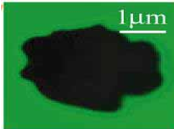
図2 紫外線レーザーで基板に穴を開けた時の穴の様子
